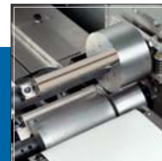
Grupo de soldadura y corte transversal Transversal sealing and cutting unit Groupe de soudure et coupe transversale RT
